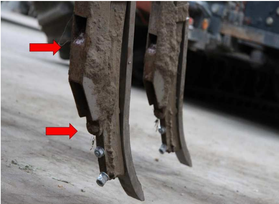
Abbildung 6: Lockerungszinke (40 mm) mit Düngeröffnungen in zwei Tiefen (Lassen, 2011)
