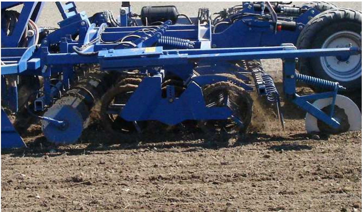
Abbildung 7: Verfüllungs- und Rückverfestigungswerkzeuge des Köckerling Master (REEB, 2012)
