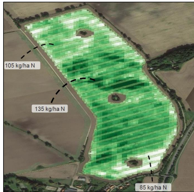
Abbildung 6: Schätzung der N-Aufnahme eines Winterrapsfeldes auf Basis einer Sentinel-2-Satellitenaufnahme mit Hilfe einer Hanse-Agro eigenen Kalibrierung. Die Fahrgassen beruhend auf einer vorherigen Sensormessfahrt sind aufgeblendet.
