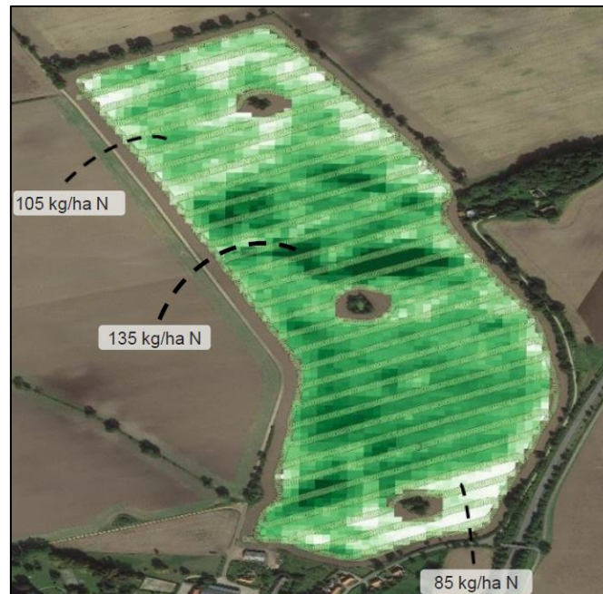
Abbildung 3: Schätzung der N-Aufnahme eines Winterrapsfeldes auf Basis einer Sentinel-2-Satellitenaufnahme mit Hilfe einer Hanse-Agro eigenen Kalibrierung. Die Fahrgassen beruhend auf einer vorherigen Sensormessfahrt sind aufgeblendet.
