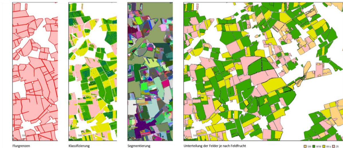
Abbildung 12: Bearbeitungsschritte der Ableitung von Schlaggrenzen und Klassifikation der Kulturarten auf Basis von Sentinel-2 Daten
