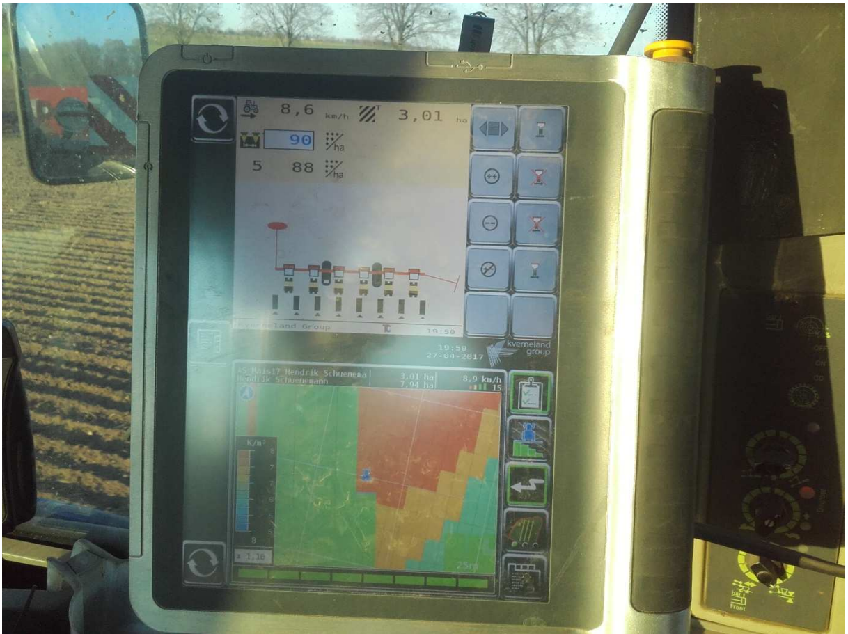
Anlage A4 das Bild zeigt das ISOBUS Terminal „Isomatch Tellus“ von Kverneland.
