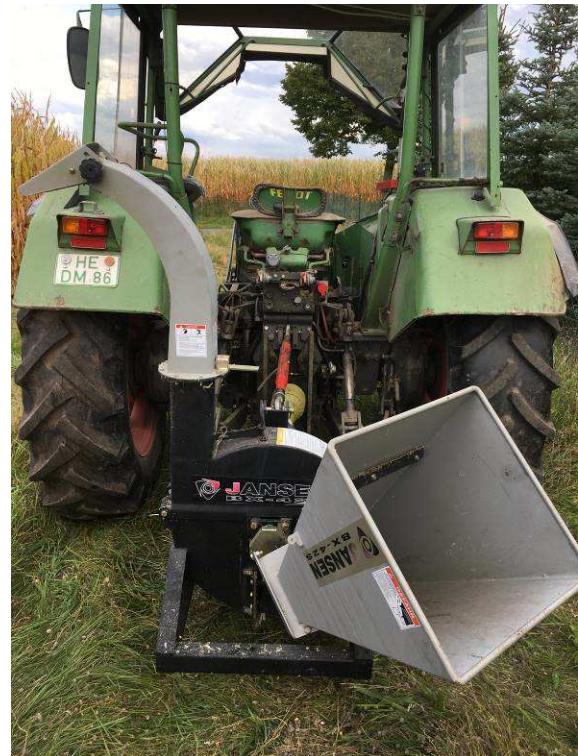
Abbildung 17: Holzhäcksler, der zur Zerkleinerung des Maises nach der Ernte genutzt wurde.
