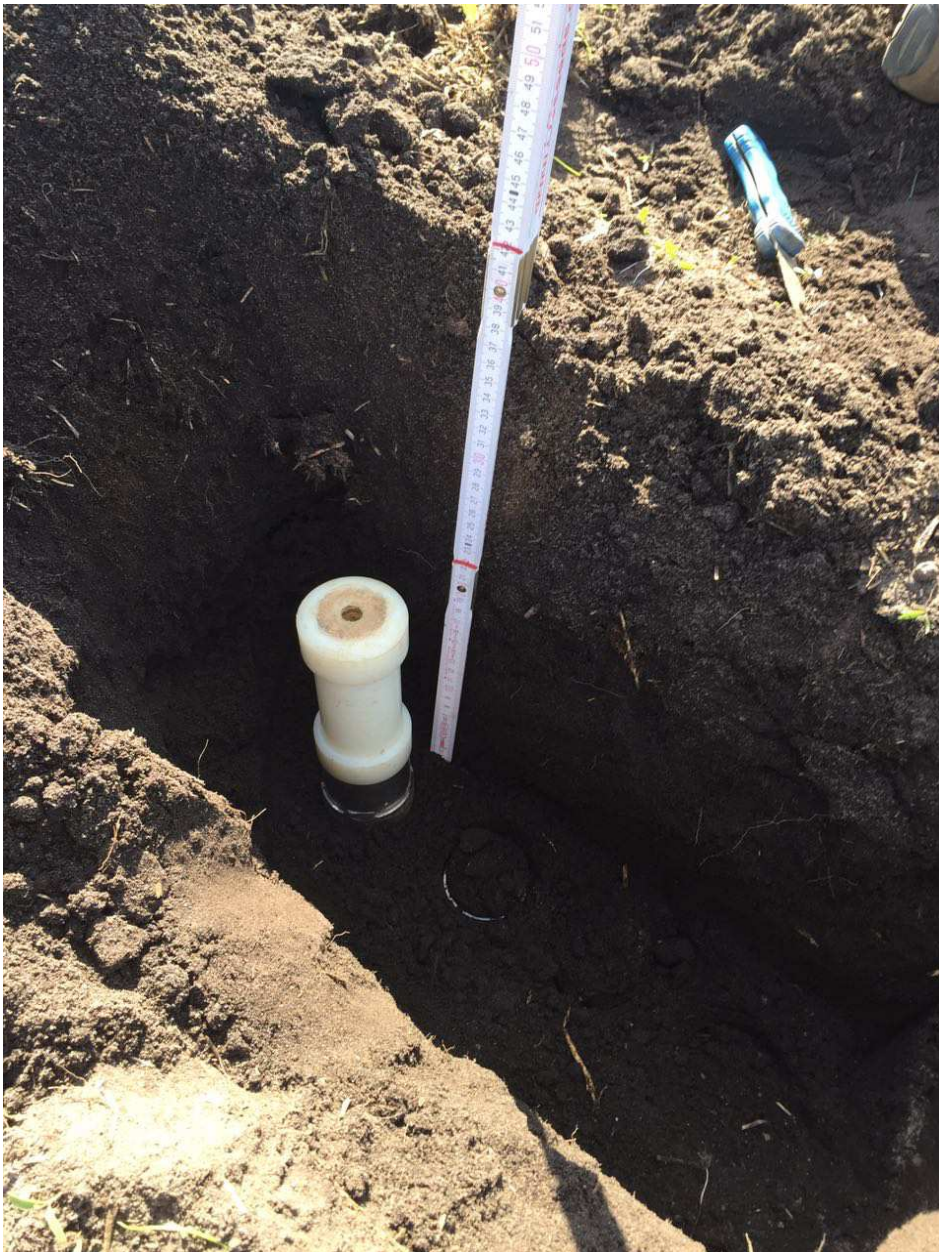
Anlage A6 Stechzylinder , die mit einem Schlageisen in dem Boden platziert wurden. Der Zollstock zeigt die Tiefe der Probenentnahme, die hier bei 35-40 cm lag, Quelle: Eigene Aufnahme, 2017
