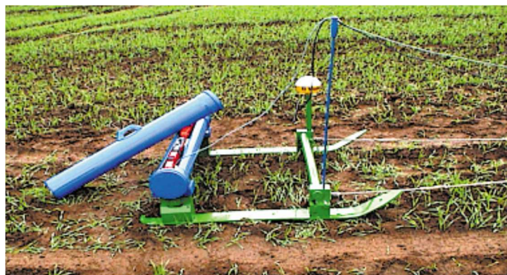
Abbildung 1: EM 38-System auf einem Messchlitten, Quelle: [Reckleben 2007].
