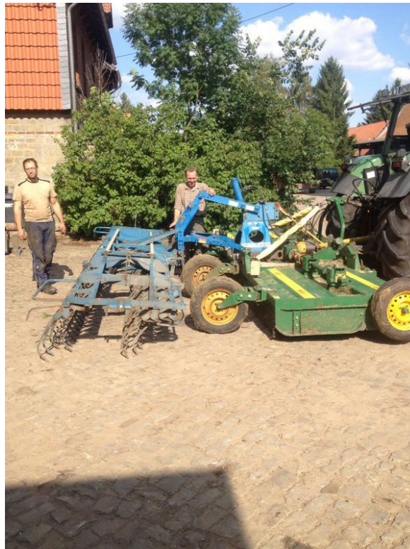
Anh. A2: Sichelmulcher der Firma Major in Kombination mit einem Strohstriegel. Quelle: Eigene Aufnahme, Juli 2014.
