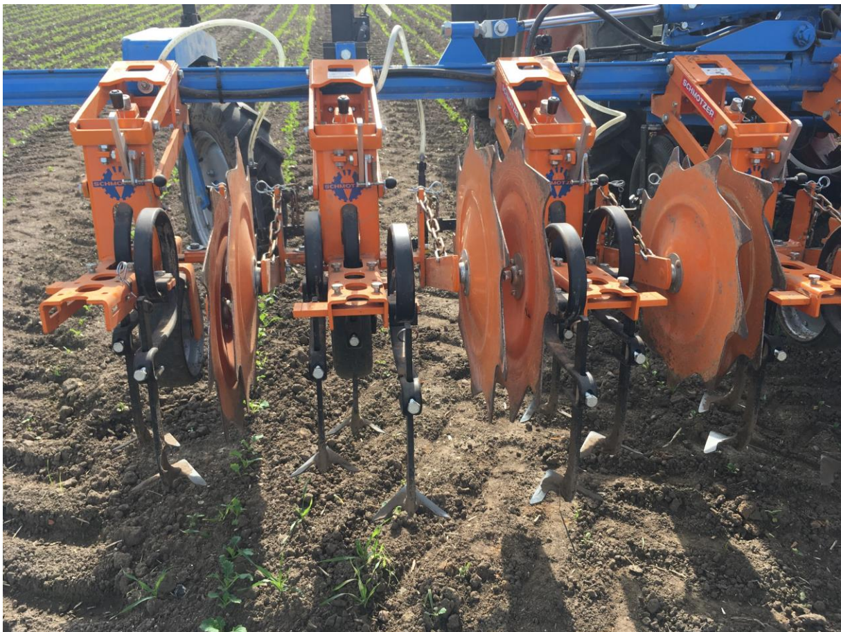
Abbildung 1 Kombi-Parallelogramm Hacke von Schmotzer auf 50 cm Reihenweite
