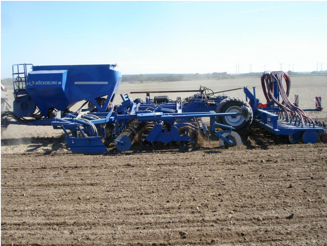
Abbildung 1 Master von Köckerling Striptillmaschine mit Unterfußdüngung und pneumatischer Säschiene
